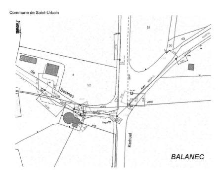
Dans le cadre des travaux de la VC3 concernant le réseau d'eau potable, il s'est avéré qu'une canalisation (600 m) était trop petite. Nous avons donc choisi de profiter de cette tranchée pour agrandir la canalisation. Le coût supplémentaire nécessite un avenant d'un montant de 20 400 € HT au marché signé avec le SPAC. Cette somme sera prélevée sur le budget eau.
